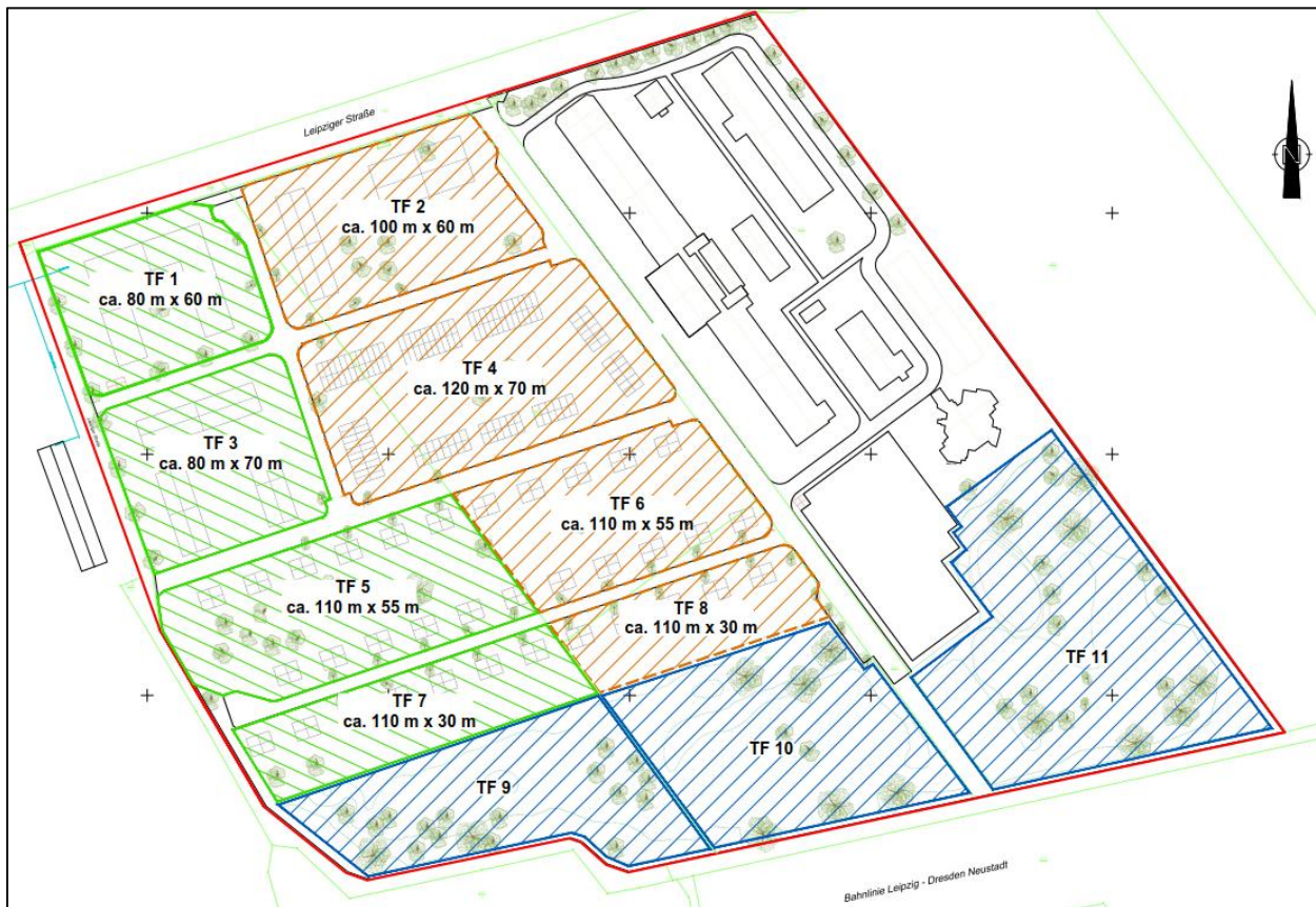
Abbildung 7-1: Lageplanausschnitt zu den vorgesehenen OMP für die Wirkungspfade Boden-Mensch und Boden-Pflanze auf baufeldbezogenen Teilflächen.
