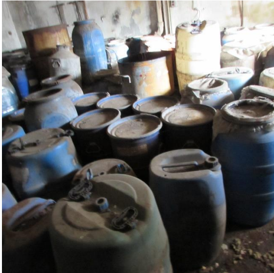
Bild 8: unsachgemäße Gebindelagerung mit Schadstoffausträgen, Dez. 2015
